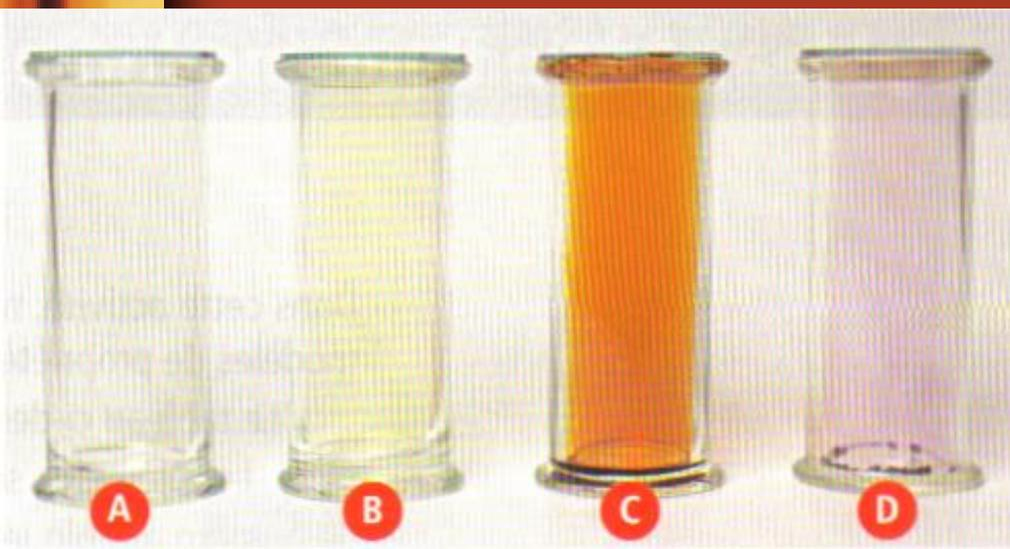
Figure 2.18 Les halogènes : le fluor (A), le chlore (B), le brome (C) et l'iode (D)
